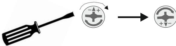
Rotare gli eccentrici (21 e 22) posizionati sui fianchi (2) e sulle tramezze (3) in senso orario in modo da fissare il coperchio e base alla tramezza ed ai fianchi. Coprire gli eccentrici (21 e 22) con i tappini copriforo (23).
