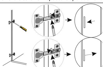
Inserire il ripiano inclinato (10) sui reggipiani (19) inseriti precedentemente sui fianchi e tramezze. Se l'apertura/chiusura delle ante non è perfetta, è necessario agire con il cacciavite sulla vite posta al centro delle cerniere, avvitando e/o svitando leggermente. In relazione al senso di rotazione della vite sulla cerniera, l'anta si avvicina o allontana dal fianco del mobile.
