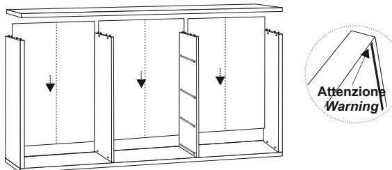
Aprire le schiene pieghevoli (4 e 5). Inserire le schiene sulla base (1), facendole scorrere nelle apposite guide poste su fianchi (2) e tramezze (3). Chiudere il telaio così ottenuto con il coperchio (1) infilandolo nei rispettivi fori posti sui fianchi e tramezze con i perni per eccentrico (20). **Attenzione: non rompere i bordi alle estremità della fresa.**
