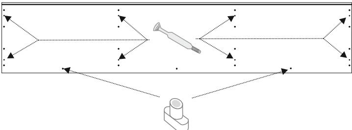
Avvitare i perni per eccentrico (20) nei fori su coperchio e base (1). Avvitarli sino a fine corsa. Inserire i fermoporta (27).
