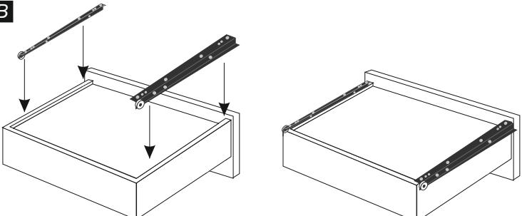
Capovolgere il cassetto e fissare le guide cassetto (14) sui bordi dx e sx sul fondo del cassetto con le viti 3,5x20 (25). Le guide vanno poste con le ruote rivolte verso l'esterno e retro del cassetto.
