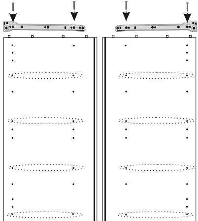
Fissare sulle tramezze (3) le guide cassetto (14) con le viti 6,3x13 (26).
