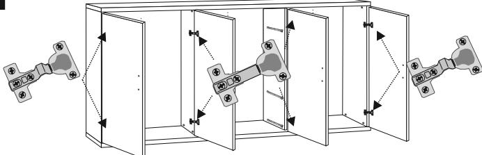
Inserire le cerniere a collo alto (13) su 2 ante (6). Sulle restanti 2 ante inserire le cerniere a collo dritto (12). Posizionare un anta con le cerniere a collo alto (13) adiacente al fianco (2), con le viti della cerniera sui rispettivi fori sul fianco e fissarle. Ripetere l'operazione sull'altro fianco con l'altra anta con le cerniere a collo alto. Ripetere l'operazione precedente con le ante con le cerniere a collo dritto (12) posizionate adiacenti alle tramezze (3) e fissatele.
